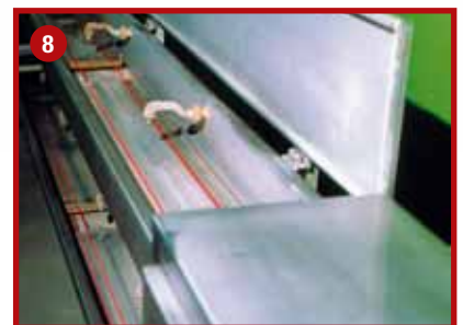
8 Damit mögliches, bei Lagerung des Kupferlitzen-Materials aufgetretenes Kondenswasser verdunstet und das flüssige PVC für die Ummantelung besser haftet, werden die Litzen vor dem Einzug in den Extruder auf 170°C erhitzt. Nach erfolgter Ummantelung und Beschriftung werden die fertigen Kabel über eine 80 Meter lange Kühlstrecke auf Raumtemperatur heruntergekühlt
