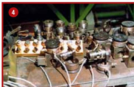
4 Je nach Kabelquerschnitt werden unterschiedliche Spritzköpfe in den Extruder eingesetzt, durch die anschließend die Kabellitzen zur Ummantelung hindurchgezogen werden
