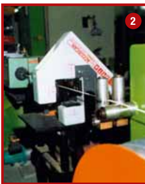
2 Lasergesteuerte Sensoren überwachen den Einzug der Litzen, damit das Kabel während des Ummantelungsvorgangs immer mit gleicher Geschwindigkeit und Zugkraft durch den Extruder läuft
