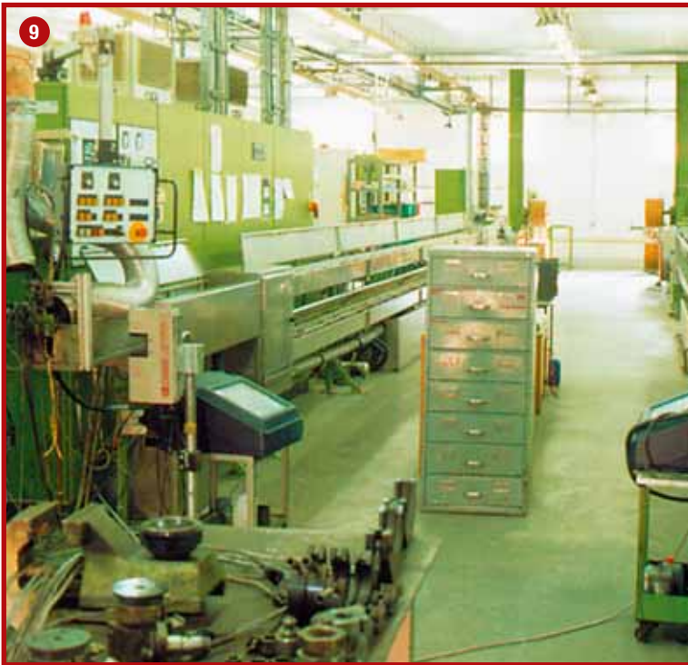
Auch am Ende der Fertigungsstraße sichern lasergesteuerte Sensoren den gleichmäßigen Einzug der noch nicht ummantelten Litzen
