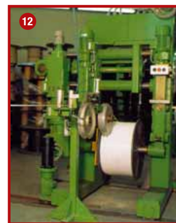
Das fertig ummantelte Kabel wird auf Fertigspulen aufgewickelt. Von dort geht es in den Handel oder wird für weitere Konfektionierungsarbeiten in andere Fabrikbereiche abtransportiert
